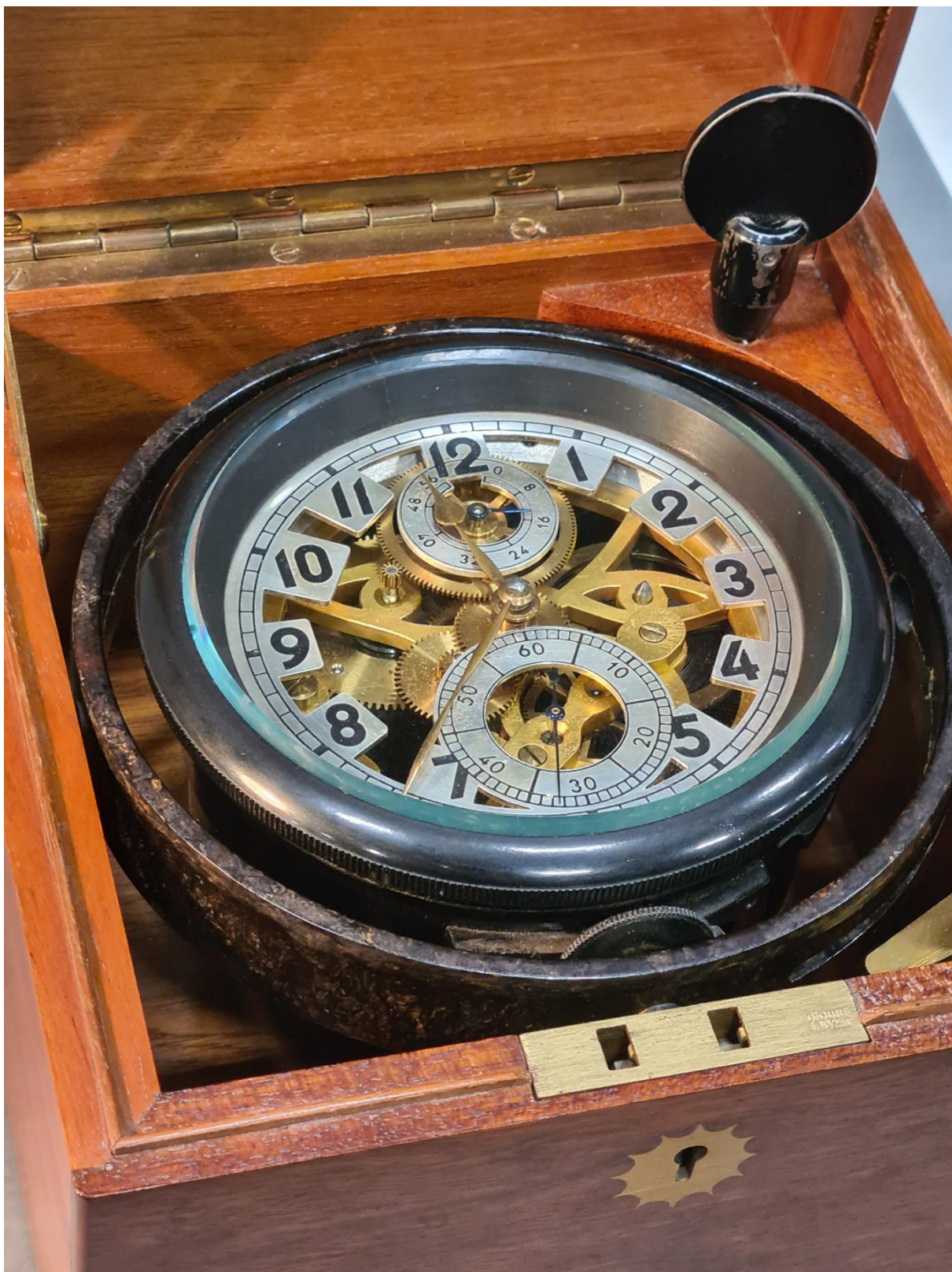
En skeletterad skeppskronometer
