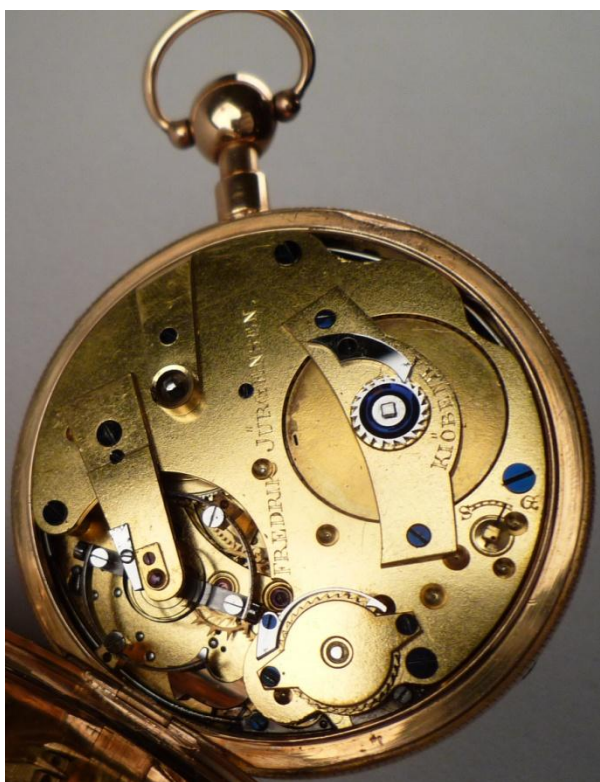
Signerat: "Fredrik Jürgensen, Kiöbenhavn", kvartsrepetition, dubbelhjulschronometergång, gåva från kung Fredrik VI till vattenbyggnadssingeniören Claus Hinrich Christensen. (x).
