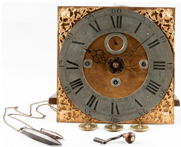
Lars Jacobsson Högberg kom som gesäll från Ystad till Malmö 1773. Golvursverket med hög detaljkvalitet har tim- och kvartsslag, datum, sekunder samt väckning. (x)(xx).
