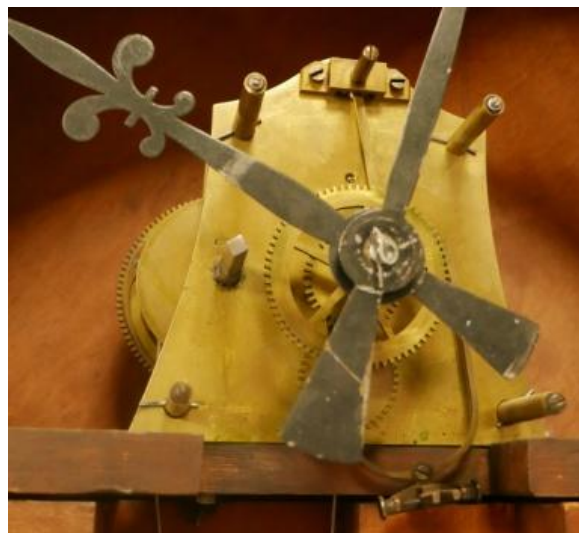
Urverk till fasaduret. OBS! - Pendelföraren!
